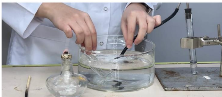
Сурет – 7 Сутек газының бөліну процессі
